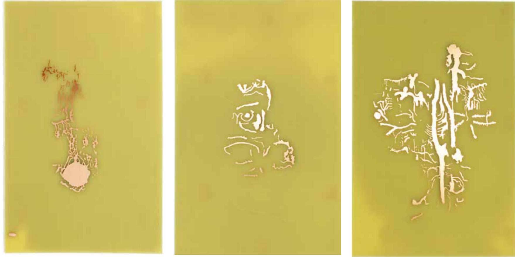
Die Bilder zeigen Fraßspuren von Borkenkäfern, die auf Leiterplatten übertragen wurden. Die Gänge bleiben durch einen Belichtungs- und Ätzprozess als Kupferzeichnung auf der Kunststoffplatte stehen. Die kupfrigen Gänge sind dann elektrisch leitend, also Leiterbahnen.
